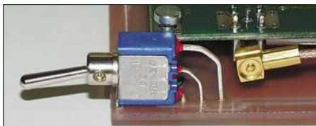
Bild 18: Nutzt man Print-Schalter, liegen ihre Bohrungen nicht mehr mittig auf der Frontplatte. Fotos: DK6RX
