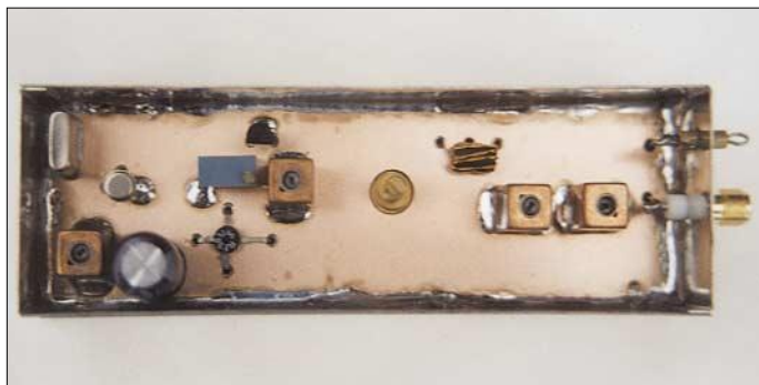
Bild 10: Quarzoszillator 116 MHz für 2-m-Transverter mit High-Level- Ringmischer [10]
