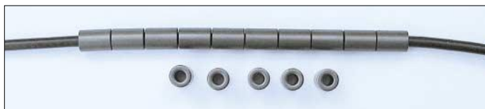
Bild 2: Ferroxcube-Ferritkerne auf RG58CU aufgezogen
