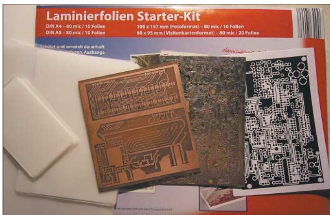
Bild 1: Mit einfachen Heißlaminierfolien lassen sich in ein paar Arbeitsschritten ohne Belichtung und Entwicklung Leiterplatten herstellen.
