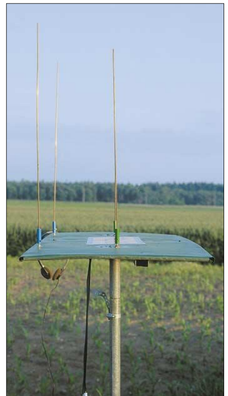
Bild 7: Das Ablezen der Peilung erfolgt von der Seite, d.h. entlang der zu den beiden Strahlern parallelliegenden Kante der Blechplatte. Fotos: DF7BL
