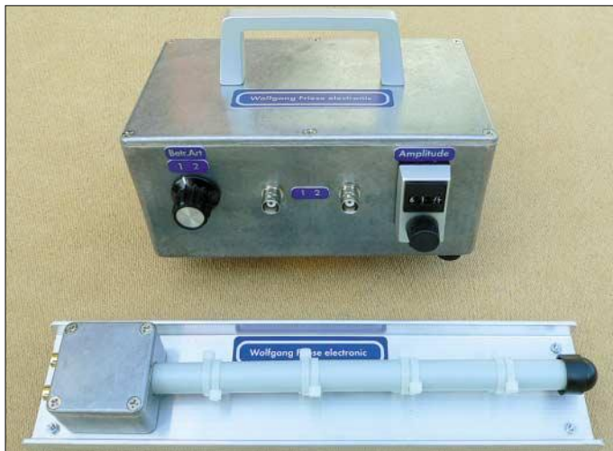
Bild 13: Ein robuster Messverstärker für den Feldeinsatz. Mit dem Umschalter links lässt sich das Übertragungsverhalten des Verstärkers zwischen linear und frequenzabhängig umschalten. Im letzteren Fall wird z.B. die Ausgangsspannung als Funktion der magnetischen Feldstärke linearisiert.
