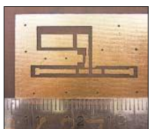
Bild 2: Selbst kleine Details wie auf dieser Platine lassen sich mit der Direkttonermethode fast perfekt herstellen.
