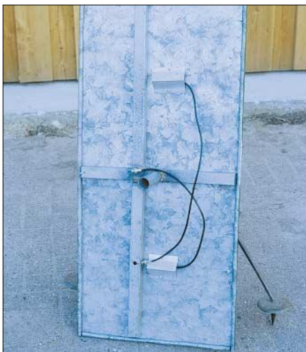
Bild 5: Unterseite der Blechplatte mit dem Kreuz aus Vierkantmaterial und dem Rohrstutzen für die Aufnahme des Stativs
