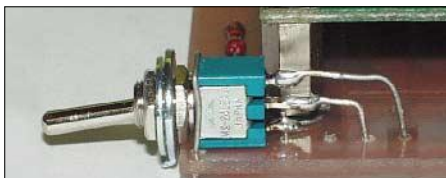
Bild 17: Auf der Platine lassen sich zwei Schaltervarianten einsetzen – hier Miniaturform über Drahtbrücken.
