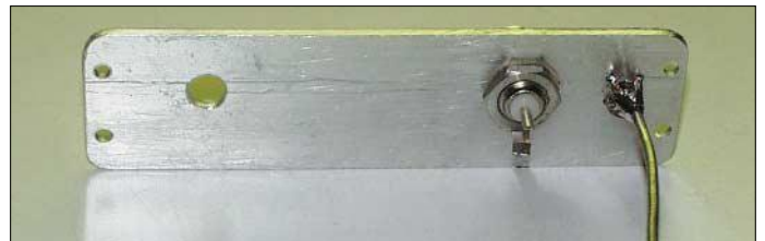
Bild 16: Als Antennenbuchse lötet man eine Print-SMB-Buchse auf die Rückwand.
