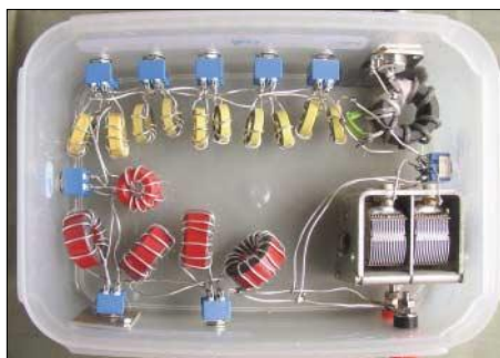
Bild 10: L-Antennenkoppler in Tiefpassschaltung, symmetrische Ausführung
