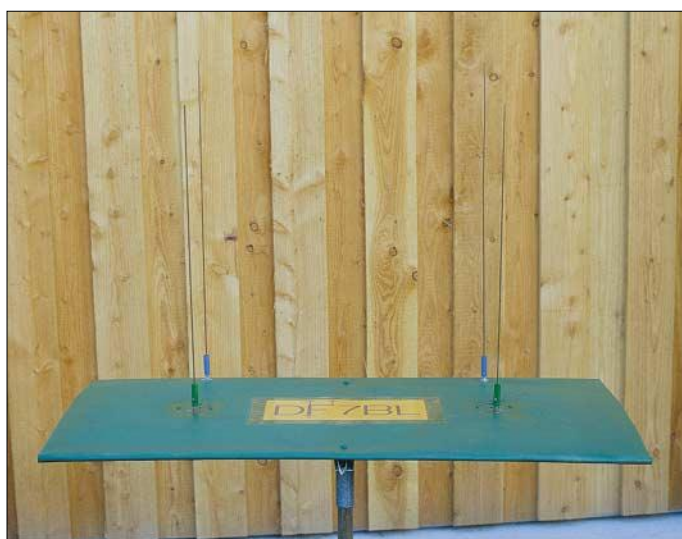
Bild 1: Ansicht der aufgebauten Peileinrichtung für das 2-m-Band
